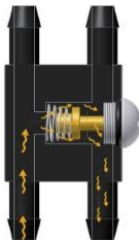
Figura 14: Válvula de desvio aberta ( www.jagg.com ).
