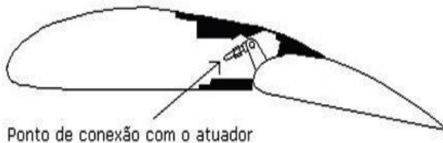
Figura 18: Modelo básico de uma asa de avião com flap.
